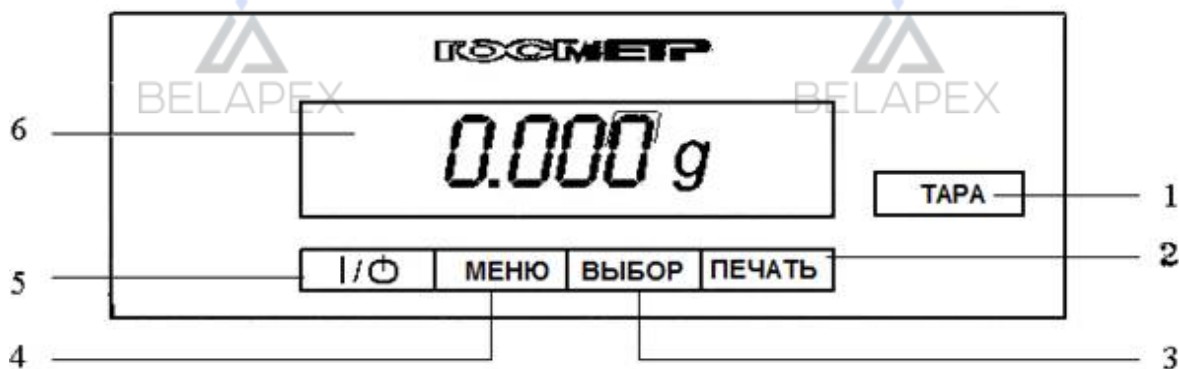
1 - клавиша ТАРА, 2 - клавиша ПЕЧАТЬ, 3 - клавиша ВЫБОР, 4 - клавиша МЕНЮ, 5 - клавиша вкл/выкл «I/O», 6 - дисплей.
